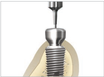
Вкручивание формирователя десны шестигранной отвёрткой 10-15 Нсм
