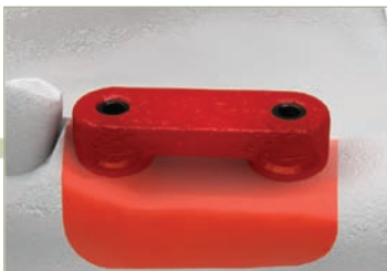
Изготовление позиционирующего шаблона
